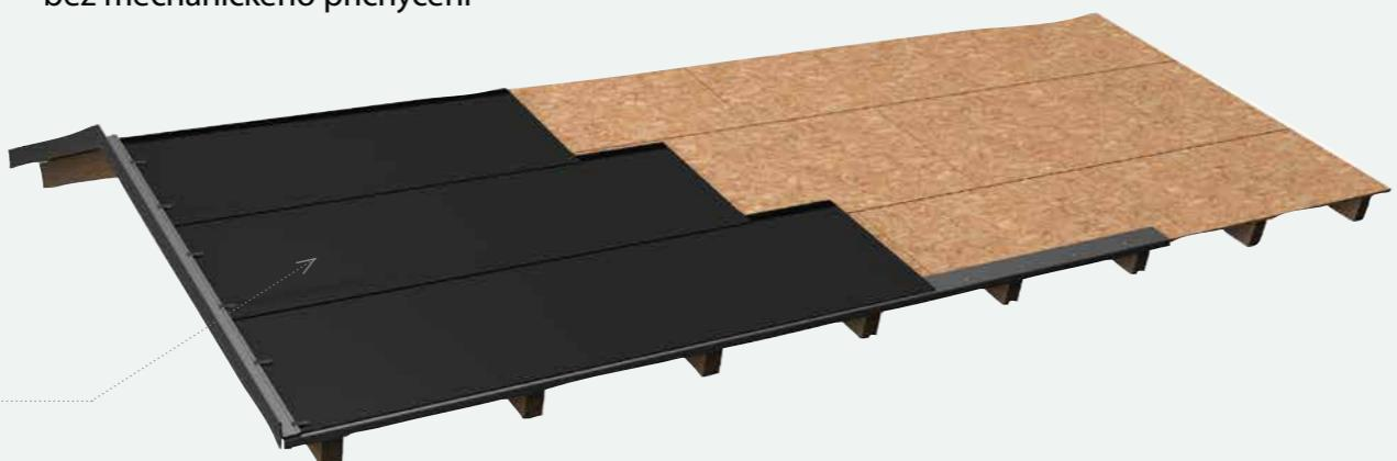
Instalujte podkladní asfaltový pás rovnoběžně s okapy – vertikální a horizontální přesahy by měly být min. 10 cm. Za teplého slunečného počasí se podkladní pás za krátkou dobu nalepí na dřevěný podklad.
